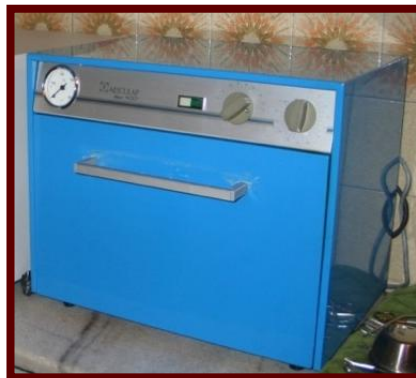
شکل ۲- ۹ : فور یا آون یا حرارت خشک یا ( نوع رومیزی یا قابل حمل tabletop oven ). اندازه دستگاه بر مبنای لیتر، حجم مفید داخلی آن است.
