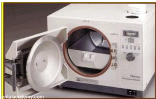
شکل ۴- ۹ : بخار شیمیایی غیر اشباع (نوع رومیزی یا قابل حمل tabletop chemiclave) اندازه دستگاه بر مبنای لیتر، حجم مفید داخلی آن است.
