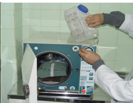
شکل ۳- ۹ : اتوکلاو یا حرارت مرطوب (نوع رومیزی یا قابل حمل tabletop autoclave) اندازه دستگاه بر مبنای لیتر، حجم مفید داخلی آن است.
