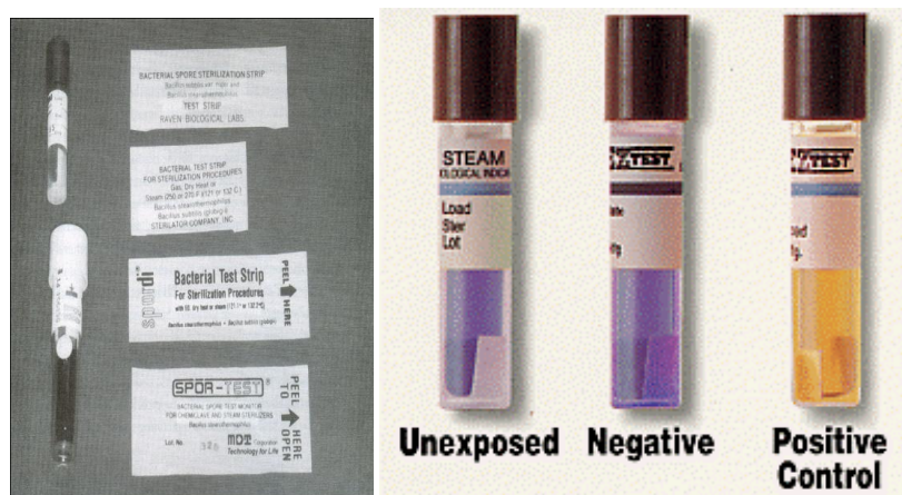
شکل ۹-۹ : نشانگرهای بیولوژیک مطمئن‌ترین روش ارزیابی کیفی استریلیزاتور ها می باشد
