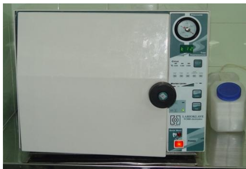
شکل ۳- ۹ : اتوکلاو یا حرارت مرطوب (نوع رومیزی یا قابل حمل tabletop autoclave) اندازه دستگاه بر مبنای لیتر، حجم مفید داخلی آن است.
