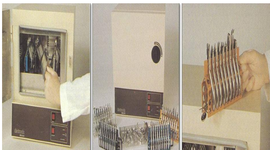
شکل ۳-۱۴: انتقال وزشی حرارت خشک (Convection Dry Heat DDS 5000) برای استریلیزاسیون پلایرهای ارتودنسی
